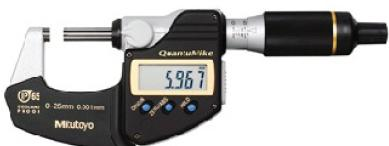
**PALMER** – Kiểm tra độ dày, do ít nhất 3 điểm khác nhau trên tấm tôn, sau đó tính độ dày bình quân các điểm so với độ dày công bố trên bề mặt sản phẩm.
